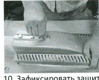
10. Зафиксировать защитную крышку винтом (барашком)
