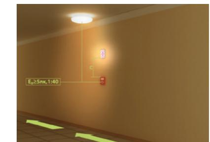
Питание световых указателей в нормальном режиме должно производиться от источника, независимого от источника питания рабочего освещения, а в аварийном режиме переключаться на питание от третьего независимого источника, например
