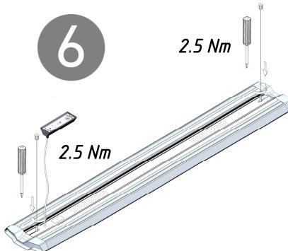
Расправить провод магистральной проводки (ПВС 3х1,5), продеть его через проходное отверстие соединительного элемента и подключить к коннектору согласно его маркировке.
