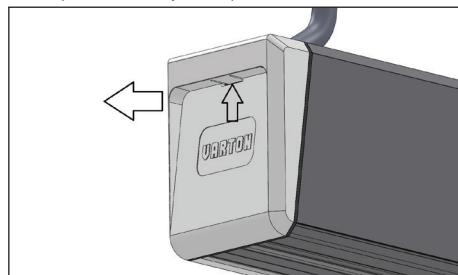
3. Выкрутите саморезы удерживающие крышки с двух сторон светильника и снимите их.
