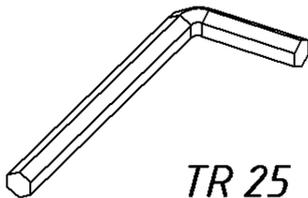
2. Розпакувати світильник. Зняти з світильника тильну частину, відкрутивши бокові гвинти ключем з головкою TR25 (входить до комплекту).
