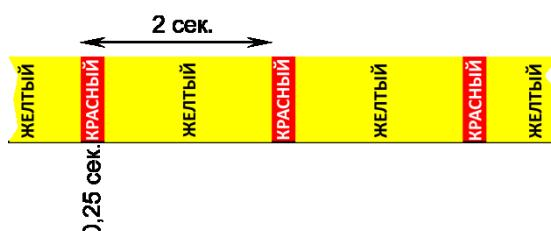
6.14. Если по окончании заряда напряжение на аккумуляторной батарее остаётся ниже 1В на элемент, то признаётся, что батарея неисправна. Зарядное устройство сохраняет пониженный ток заряда. Светодиодный индикатор светового прибора горит зелёным, но периодически через 2 секунды мигает красным секунды на 0,25 секунды, показывая низкое напряжение батареи. Если световой прибор подключен к ЩАО BS-ACTEON-2, то групповой индикатор «АО НОРМА» в ЩАО BS-ACTEON-2 гаснет до устранения неисправности.
