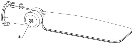
2. Подключить сетевые провода, соблюдая полярность: L – «коричневый», N – «синий», GND – «зелено-желтый»
