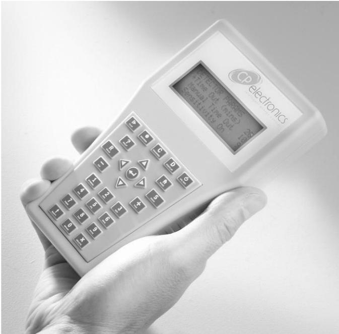
UNLCDHS — это компактный инфракрасный пульт для дистанционного управления, настройки и программирования датчиков с функцией программирования с помощью ИК-сигнала и (или) радиочастот.
