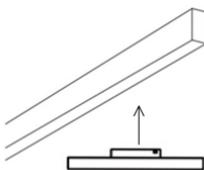
3. При демонтаже светильника, зажать фиксаторы на боковых частях адаптера светильника и вытащить его из шинопровода.
