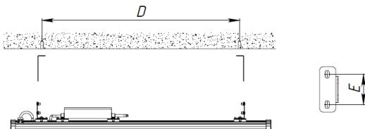
3. Установить на светильник поворотные кронштейны (2шт.) из пакета с комплектацией с помощью винтов M5x10 и шайб.
