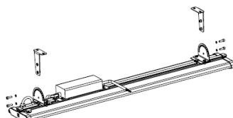
5. Подключить питание к светильнику с помощью герметичных коннекторов (в комплект поставки не входят) или герметичных распределительных коробок (в комплект поставки не входят) в соответствии с указанной полярностью: «L» фаза - коричневый; «N» ноль - синий; заземление - желто-зеленый.
