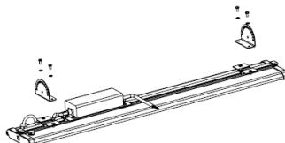
4. Установить светильник на потолочные кронштейны с помощью винтов M5x16 и шайб, отрегулировать угол наклона при помощи поворотных кронштейнов и затянуть винты M5 кронштейна.
