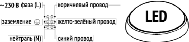
Рис.1. Схема подключения светодиодного светильника к эклектической сети 230В.
